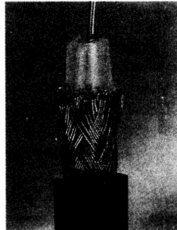
Hình 19-5. Một dây cáp đồng trục là một tụ điện trụ. Một dây dẫn đặt bên trong chạy xuyên qua giữa một vật liệu cách điện bằng chất dẻo. Vật liệu này được bao quanh bởi một vỏ bằng dây dẫn bên lại. Dây bên lại được bọc ngoài bằng lớp vỏ cao su cách điện.
