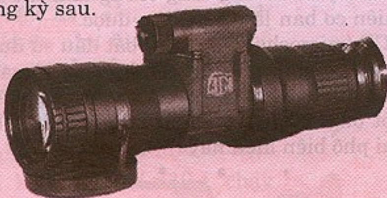
Hình 2. Ống nhòm để nhìn thấy ban đêm. Phía trước là ống tăng cường ảnh, trên là ống chiếu hồng ngoại.
